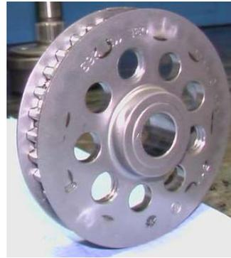
**Bild 3-4:** Gesinterte Zahnriemenräder – Antriebsrad (22 Zähne) und getriebenes Rad (33 Zähne)
