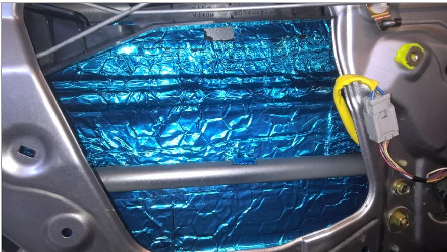
Bei der Innenseite auch so vorgehen. Aufpassen, dass dem Türöffner-Gestänge genug Platz bleibt. Alle nicht benötigten Öffnungen überkleben, aber diejenigen für die Clips der Türverkleidung auslassen. Die große Öffnung für den Styroporklotz an der Türverkleidung habe ich im oberen Drittel überklebt und dann für den Styroporklotz nach Augenmaß ausgeschnitten und umgelegt.
