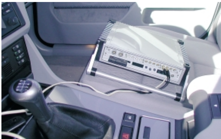
Das mobile Frontend PAK-Mobil MK II nimmt die Signale der Sensoren im Fahrzeug wie Motordrehzahl und Gaspedalstellung entgegen
