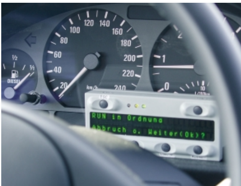
Das Miniterminal des PAK-Messsystems dient der Anzeige der Daten im Fahrzeug, die für den Testbetrieb relevant sind
