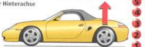
Die aerodynamischen Anlagen des neuen Honda S 2000 sind allenfalls befriedigend entwickelt. Das Fragment von Heckspoiler hat keinen spürbaren Effekt. Der Auftrieb an der Hinterachse ist mit 600 Newton sehr hoch. Auch an der Vorderachse ist eine deutliche Auftriebswirkung festzustellen: 324 Newton. Die aerodynamische Balance ist damit nicht sehr ausgewogen. Der Luftwiderstandsbeiwert ( $c_w$ ) beträgt 0,38. In offenem Zustand erhöht er sich erwartungsgemäß auf 0,46.
