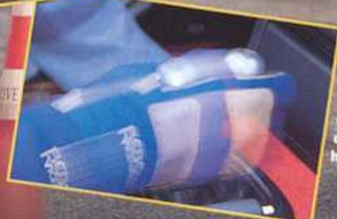
■ 23 Millimeter nach vorn, maximal 40 Millimeter zur Seite: der kurze Schalthebel als Joystick
