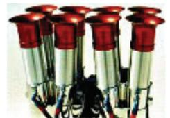
⚠ Es waren keine Düsen zum Zweck den „dynamischen Druck einzufangen“. Denn sie befanden sich nicht im Luftstrom des Fahrtwindes. Außerdem waren die Durchmesserunterschiede gering. Wichtig ist die Abrundung am oberen Ende. Sie dienten dazu einen möglichst strömungsgünstigen also aerodynamischen Lufteinlass zu bilden.
